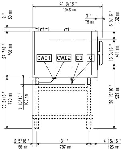
CWI1 = Kaltwasserzulauf      EI = Elektroanschluss
